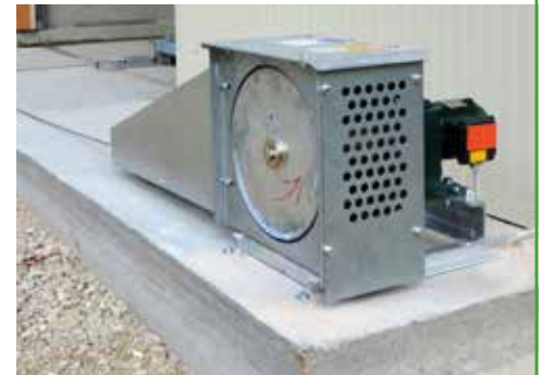
Robuste Antriebswinde am Boden montiert.
