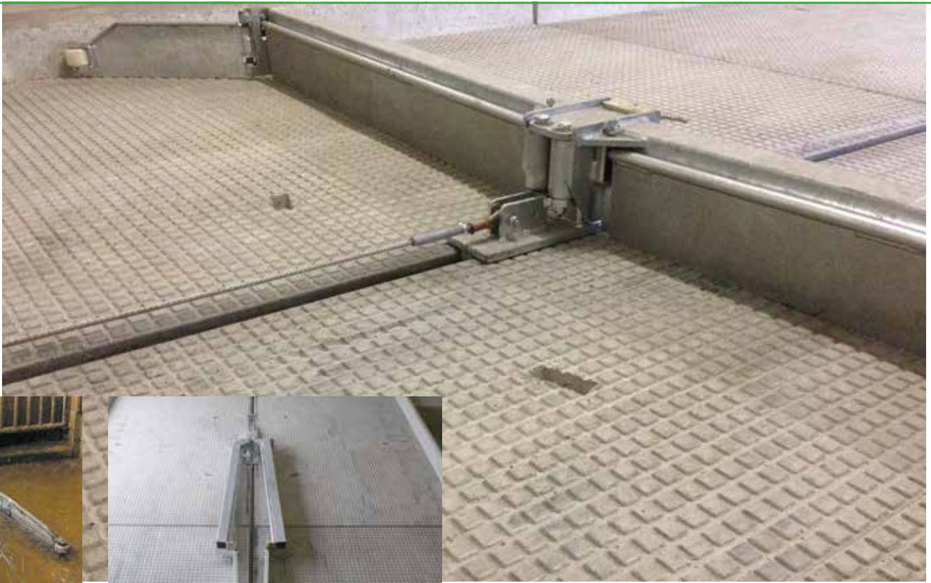
Breitschieber schnell zusammengeklappt für die Durchfahrbarkeit.
